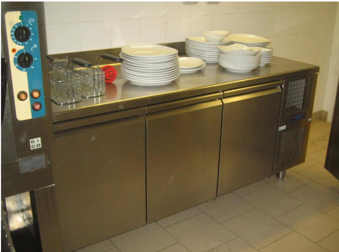
**Figura 5 - n.1 tavolo refrigerato a 3 porte con motore incorporato**
