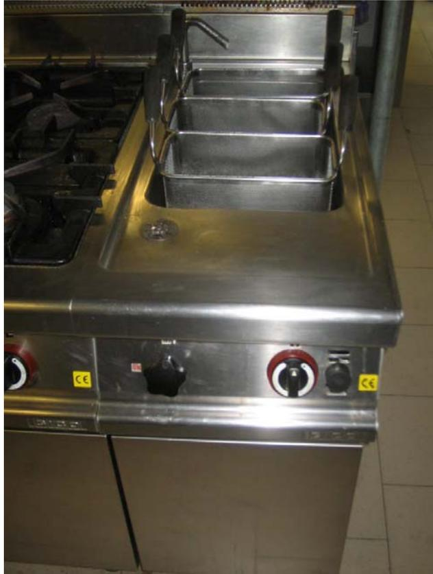
**Figura 10 - n. 1 cuocipasta a gas singolo completo di cesti da 1/3**
