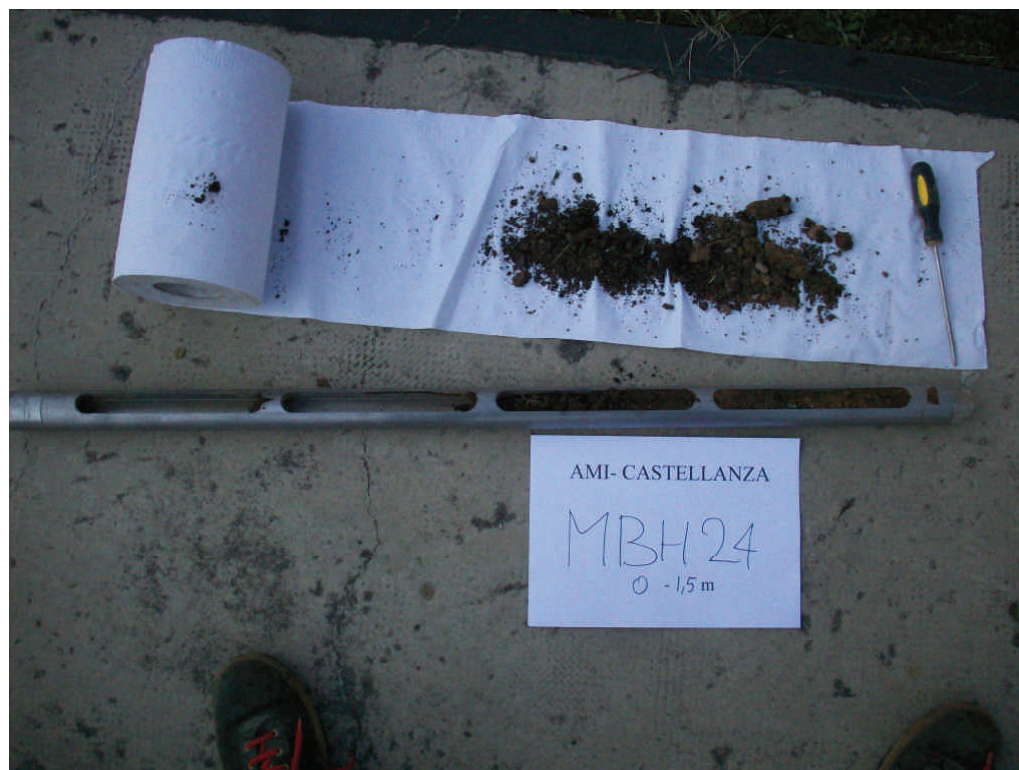
Figura .45 Microsondaggio MBH24 da 0 a 1,5 m da p.c.
