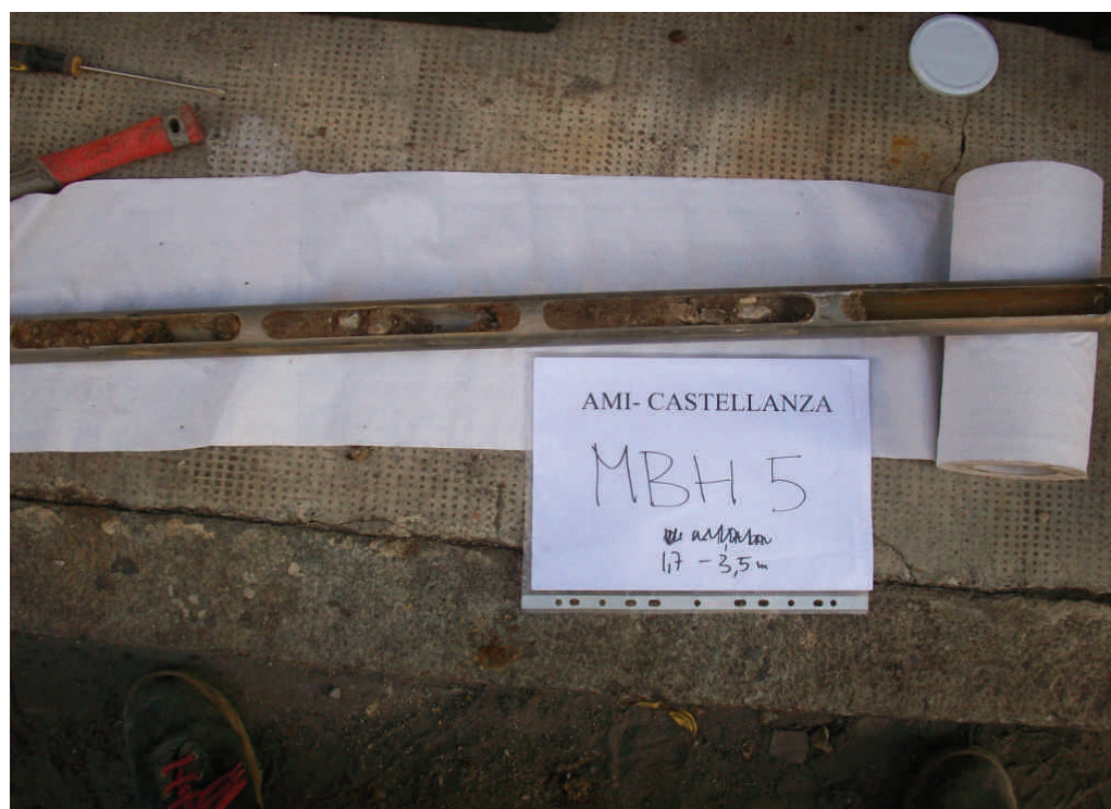
Figura .8 Microsondaggio MBH5 da 1,7 a 3,5 m da p.c.
