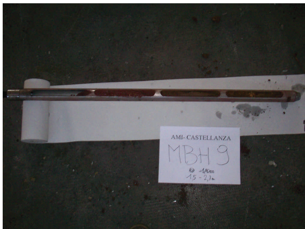
Figura. 16 Microsondaggio MBH9 da 1,5 a 2,7 m da p.c.
