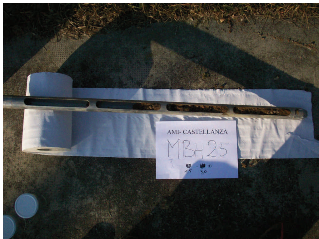
Figura .48 Microsondaggio MBH25 da 1,5 a 3 m da p.c.
