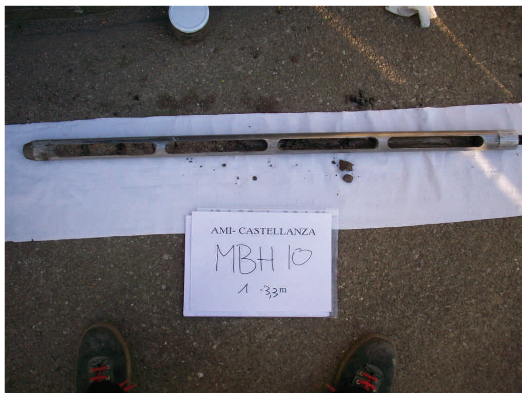
Figura.18 Microsondaggio MBH10 da 1 a 3,3 m da p.c.
