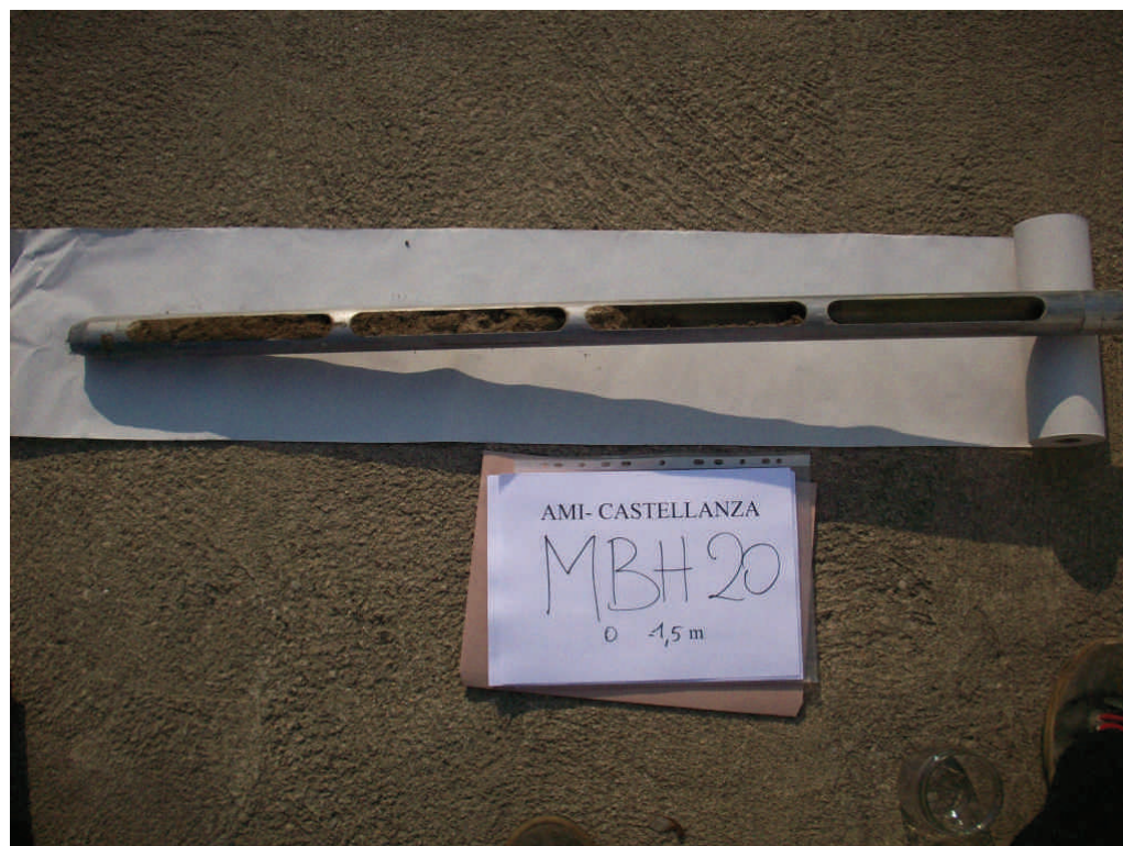
Figura .37 Microsondaggio MBH20 da 0 a 1,5 m da p.c.
