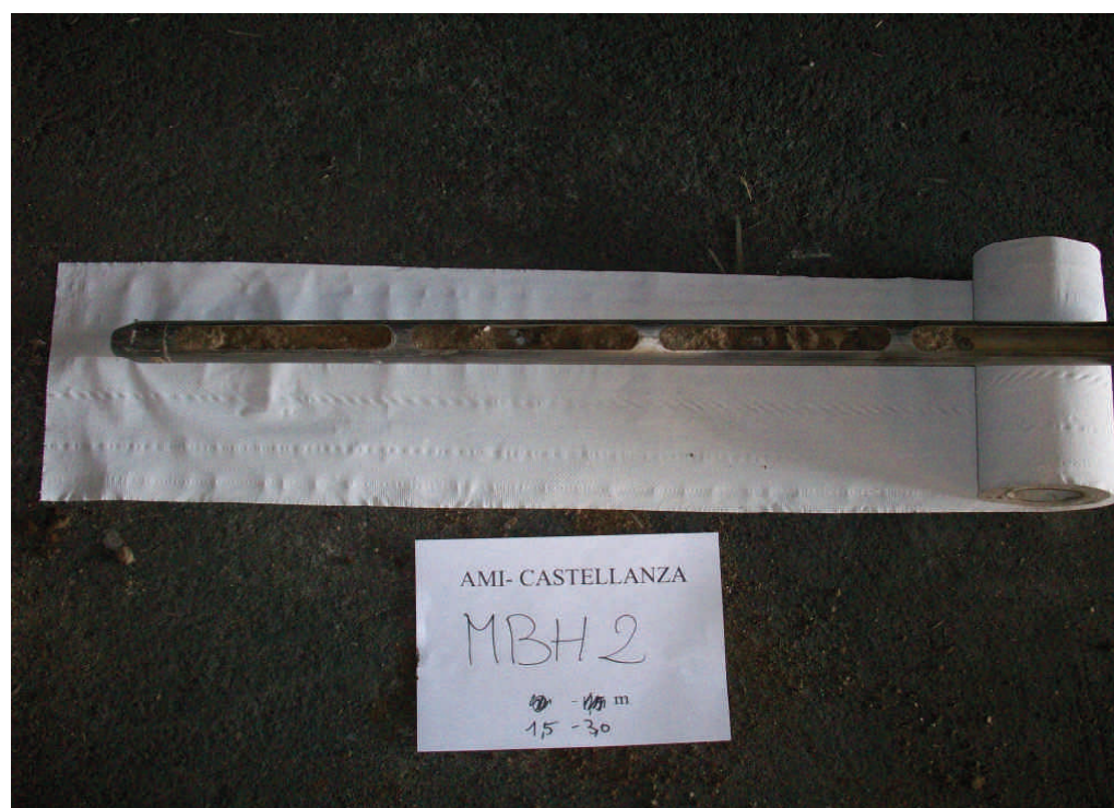
Figura. 2 Microsondaggio MBH2 da 1,5 a 3 m da p.c.
