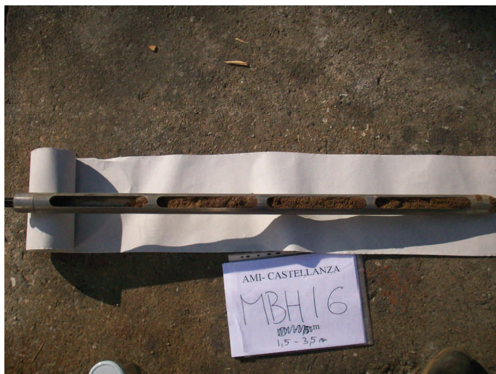
Figura .30 Microsondaggio MBH16 da 1,5 a 3,5 m da p.c.
