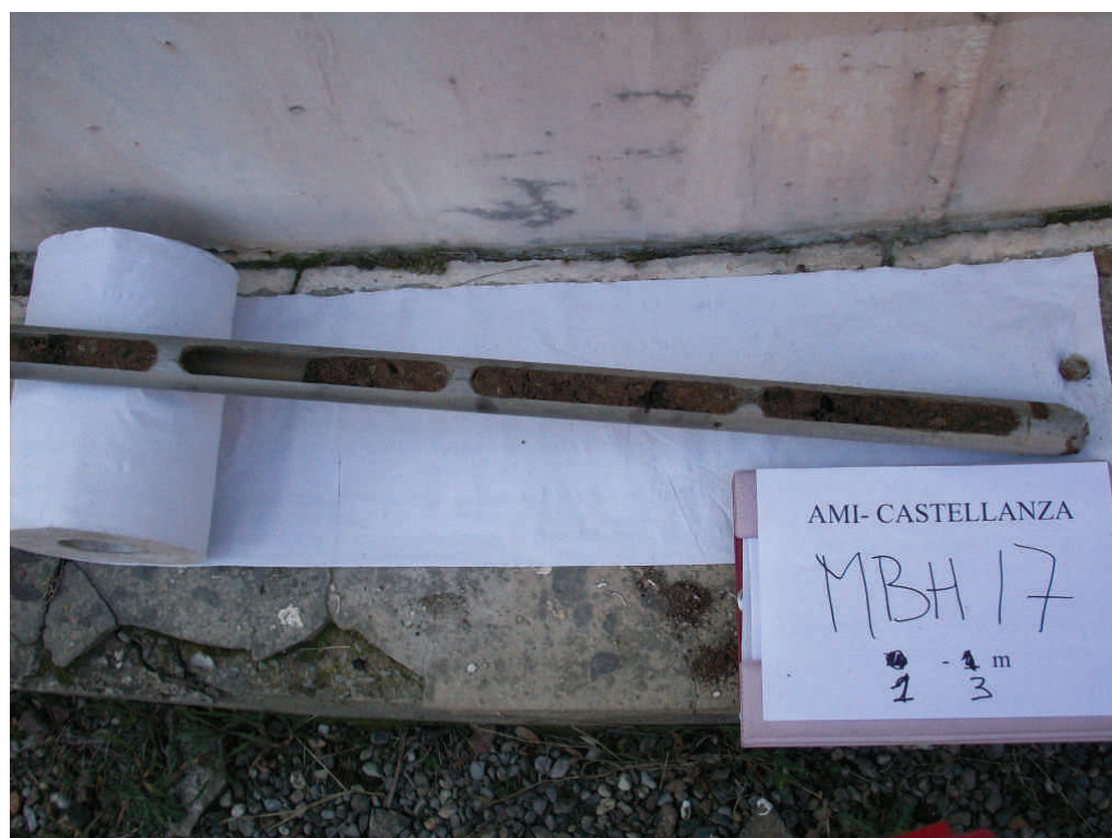
Figura .32 Microsondaggio MBH17 da 1 a 3 m da p.c.
