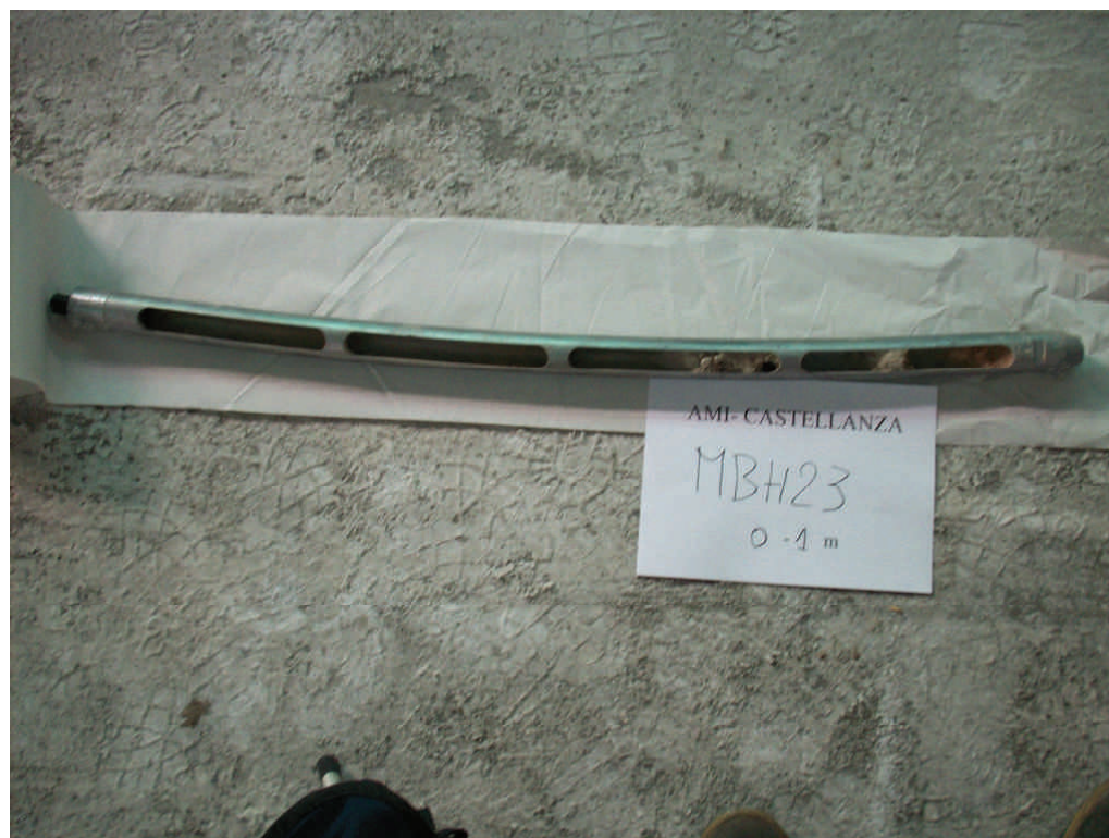
Figura .43 Microsondaggio MBH23 da 0 a 1 m da p.c.
