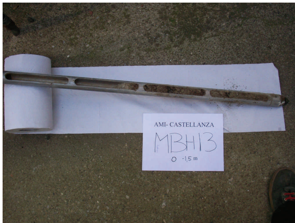
Figura .23 Microsondaggio MBH13 da 0 a 1,5 m da p.c.
