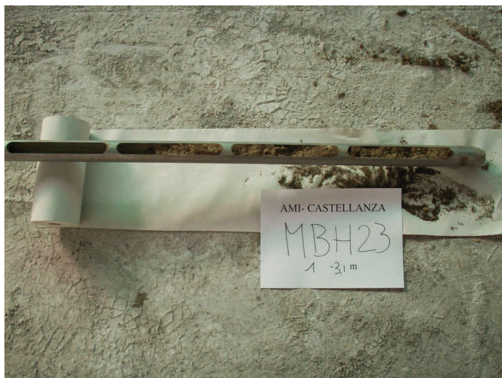
Figura .44 Microsondaggio MBH23 da 1 a 3,1 m da p.c.
