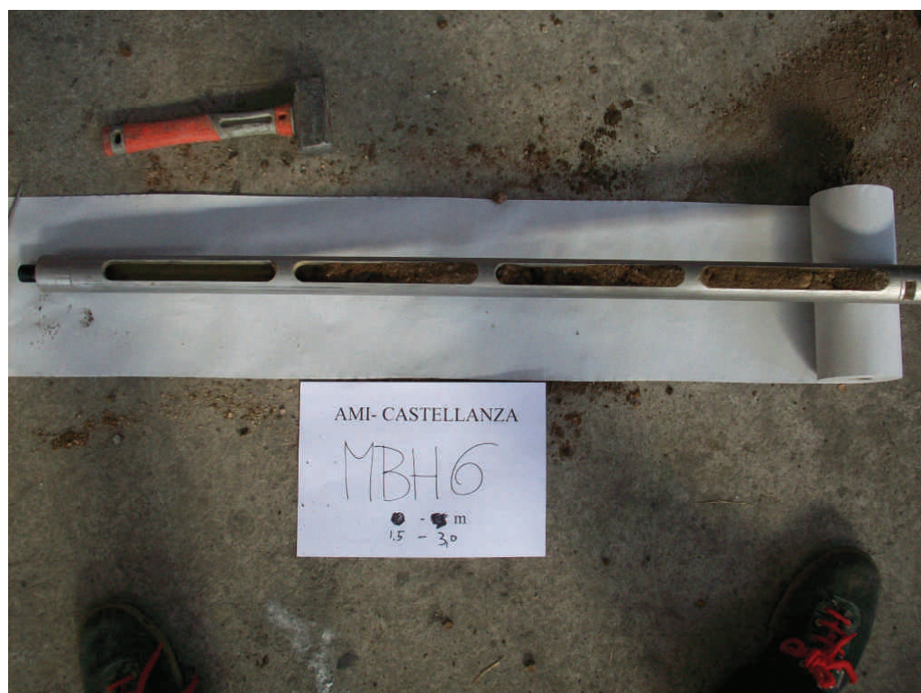
Figura .10 Microsondaggio MBH6 da 1,5 a 3 m da p.c.
