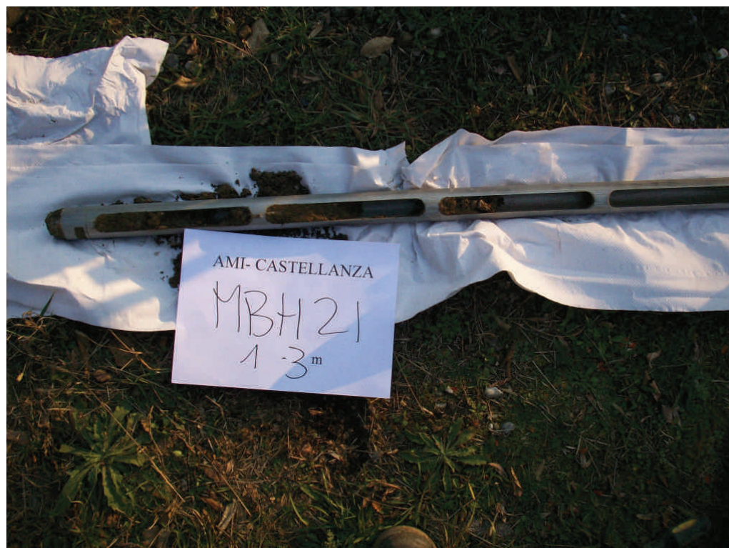
Figura .40 Microsondaggio MBH21 da 1 a 3 m da p.c.
