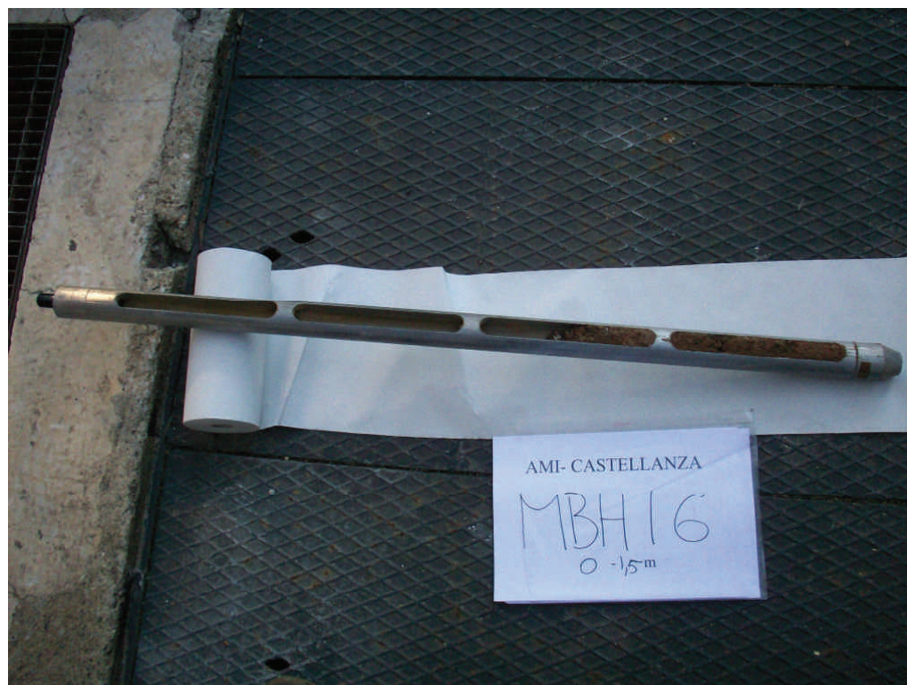
Figura .29 Microsondaggio MBH16 da 0 a 1,5 m da p.c.
