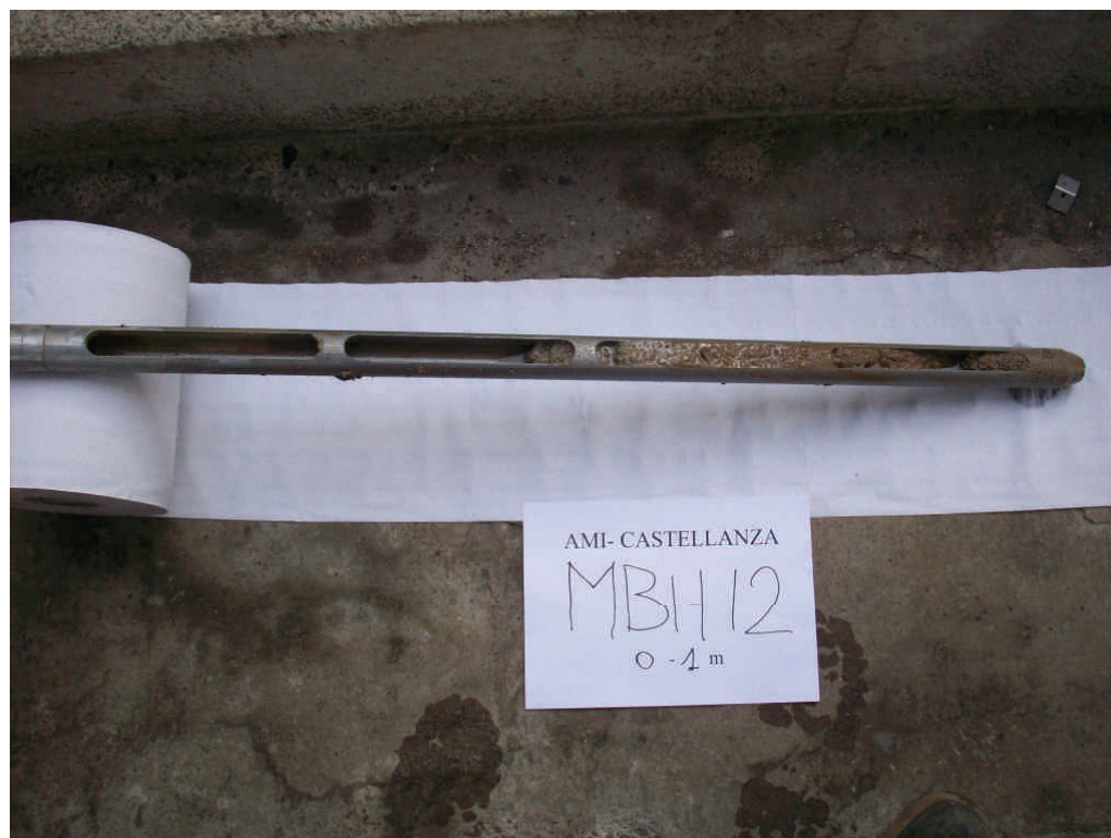
Figura .21 Microsondaggio MBH12 da 0 a 1 m da p.c.
