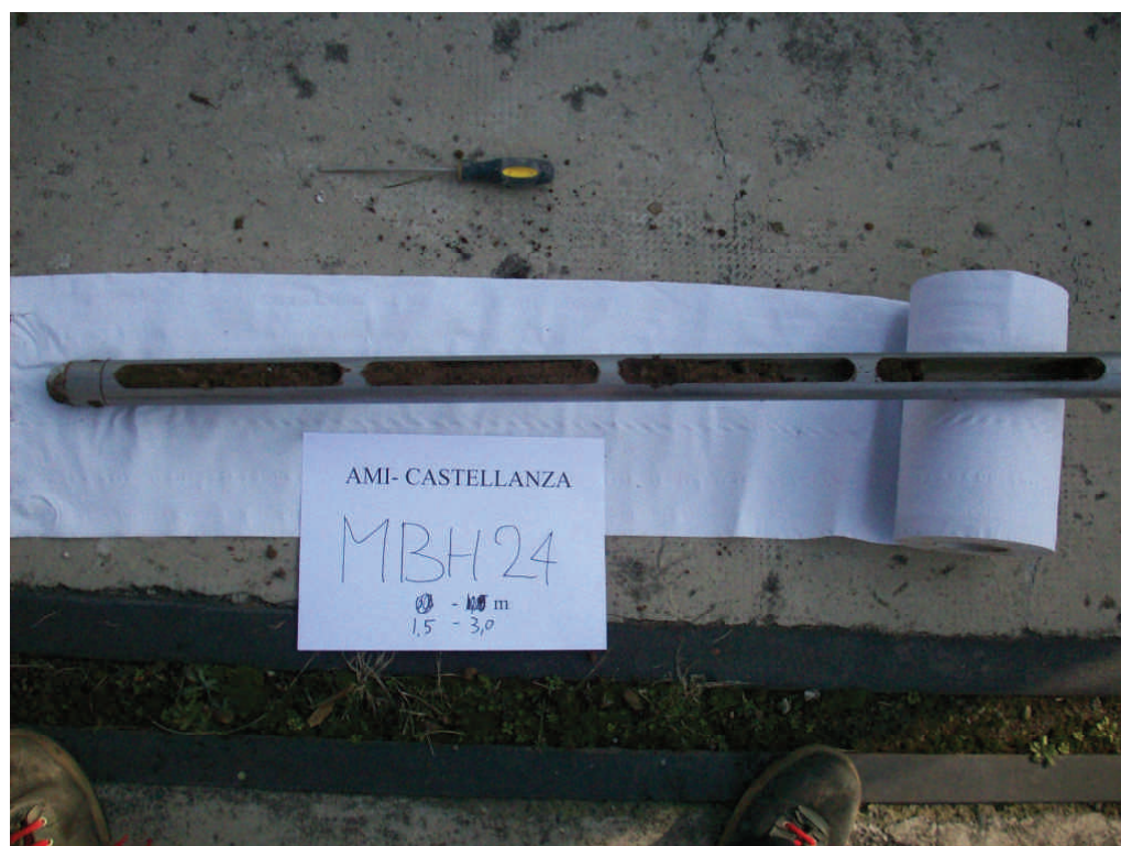
Figura .46 Microsondaggio MBH24 da 1,5 a 3 m da p.c.
