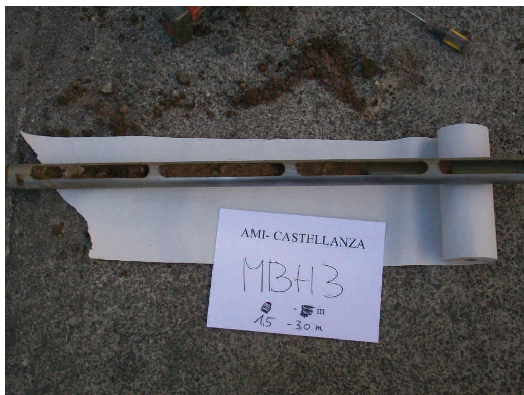
Figura. 4 Microsondaggio MBH3 da 1,5 a 3 m da p.c.
