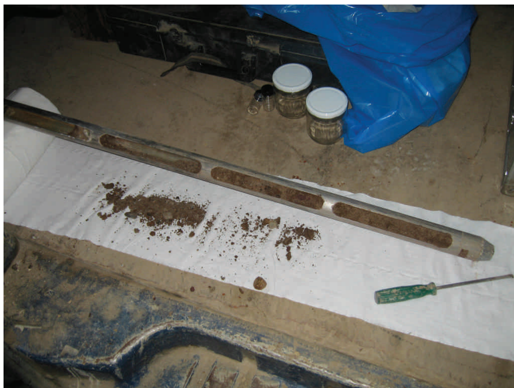
Figura .57 Microsondaggio MBH30 da 0 a 1 m da p.c.
