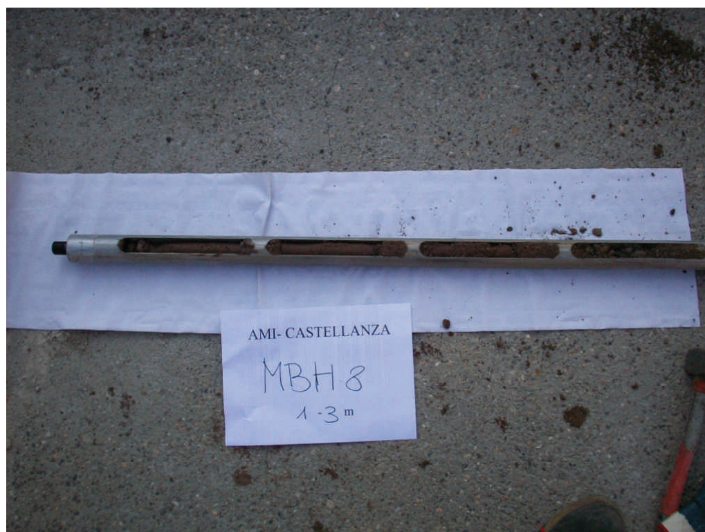
Figura .14 Microsondaggio MBH8 da 1 a 3 m da p.c.
