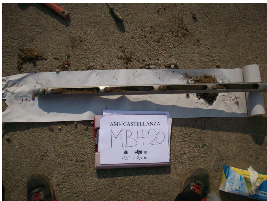
Figura .38 Microsondaggio MBH20 da 1,5 a 2,5 m da p.c.
