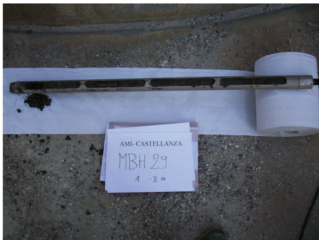
Figura .56 Microsondaggio MBH29 da 1 a 3 m da p.c.
