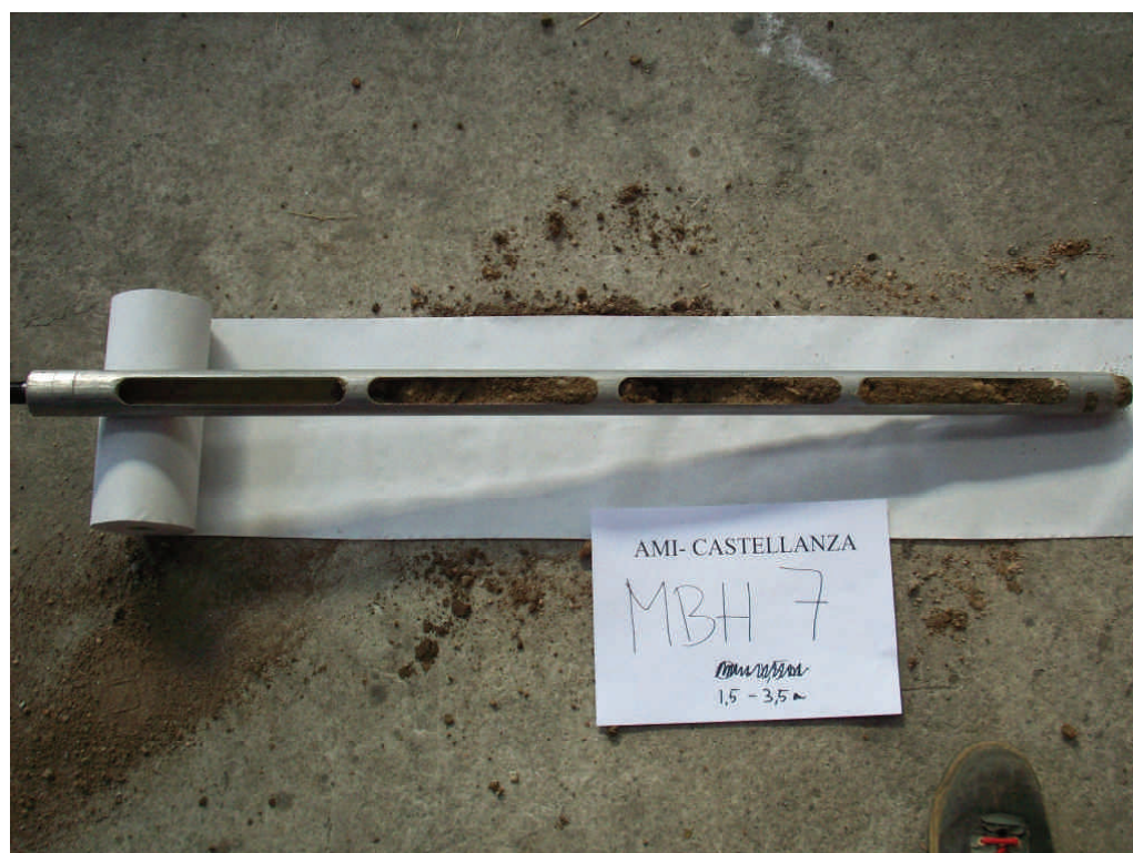
Figura. 12 Microsondaggio MBH7 da 1,5 a 3,5 m da p.c.
