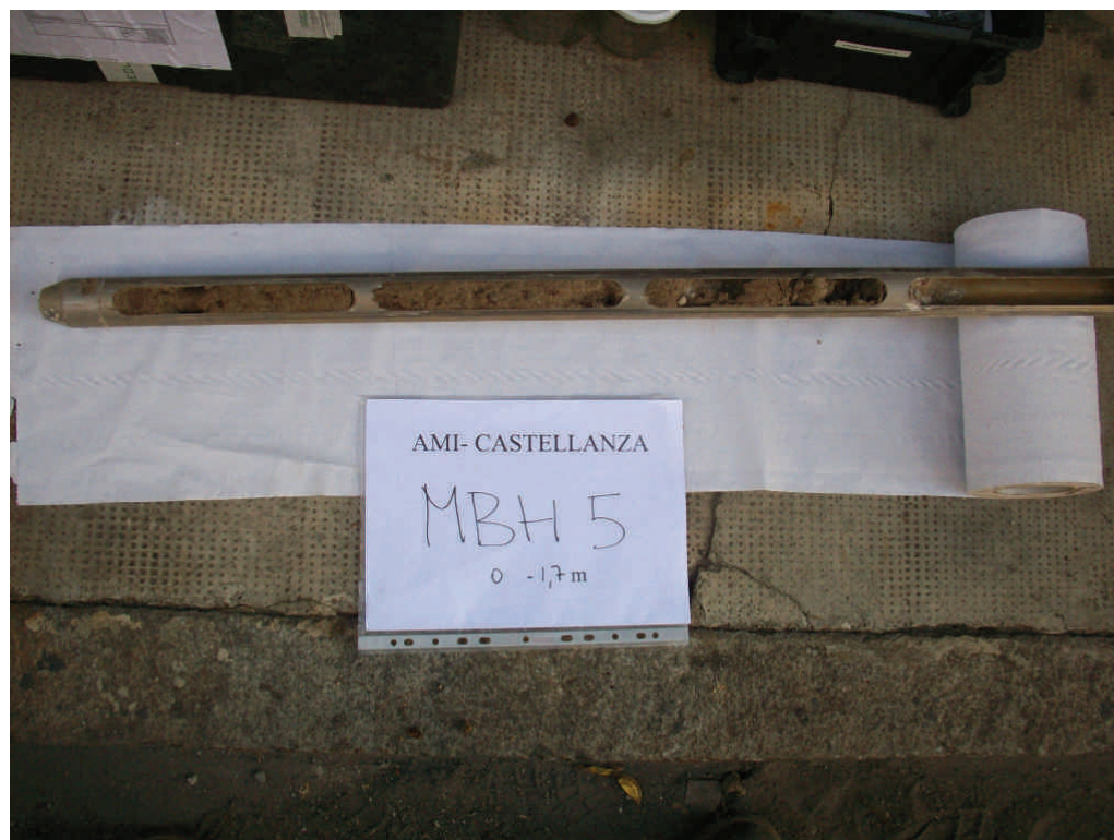
Figura .7 Microsondaggio MBH5 da 0 a 1,7 m da p.c.
