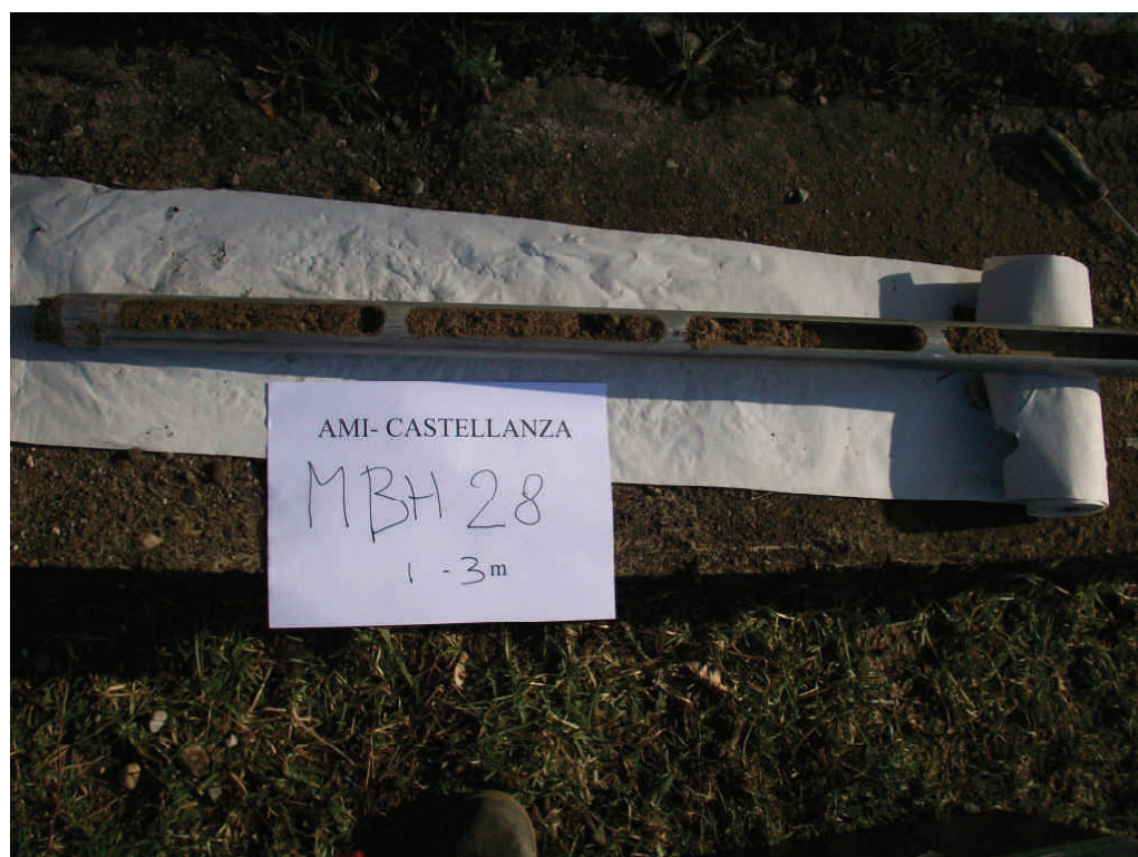
Figura .54 Microsondaggio MBH28 da 1 a 3 m da p.c.
