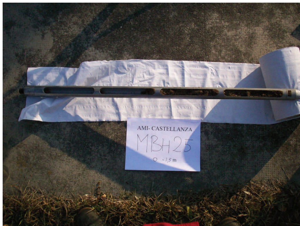
Figura .47 Microsondaggio MBH25 da 0 a 1,5 m da p.c.
