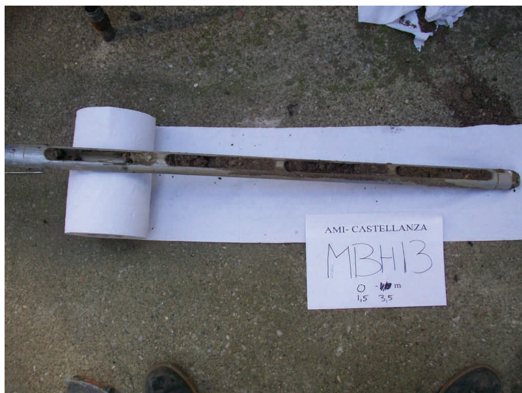
Figura .24 Microsondaggio MBH13 da 1,5 a 3,5 m da p.c.
