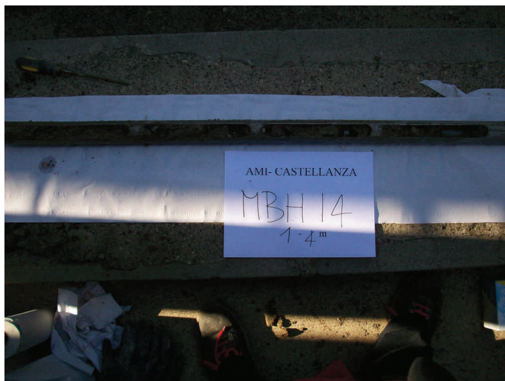
Figura .26 Microsondaggio MBH14 da 1 a 4 m da p.c.
