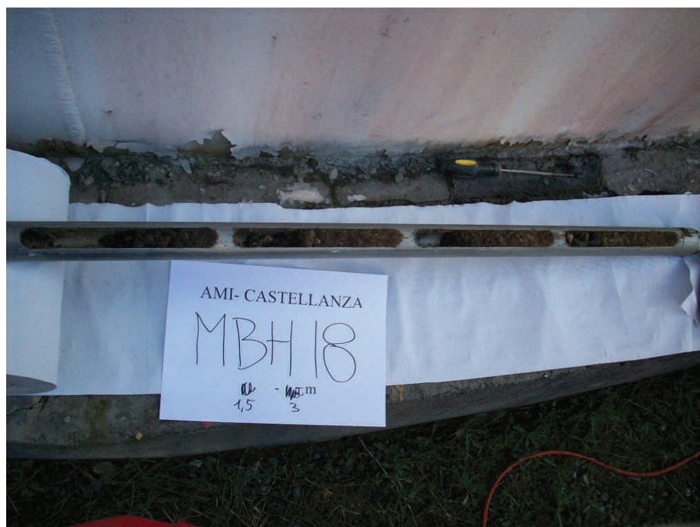
Figura .34 Microsondaggio MBH18 da 1,5 a 3 m da p.c.
