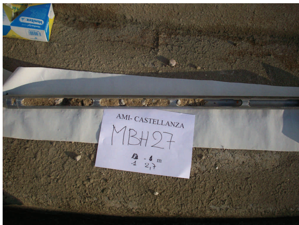
Figura .52 Microsondaggio MBH27 da 1 a 2,7 m da p.c.
