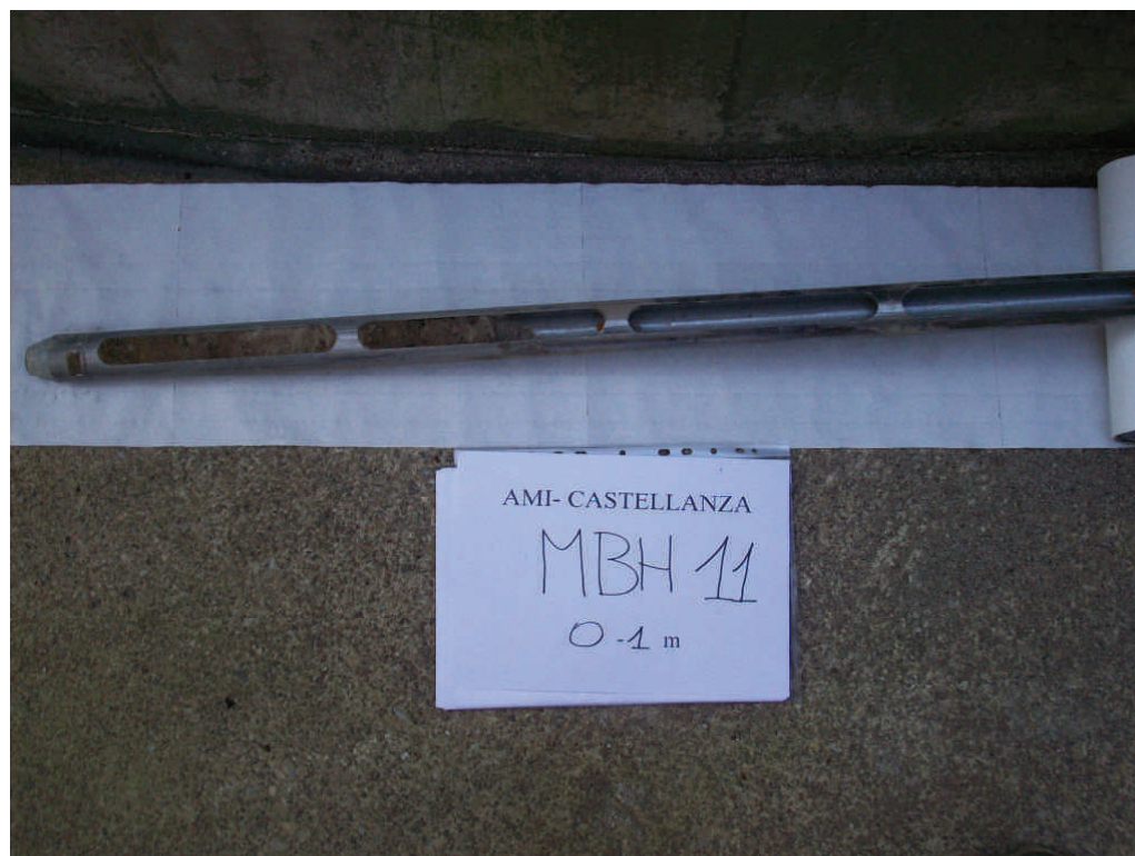
Figura.19 Microsondaggio MBH11 da 0 a 1 m da p.c.
