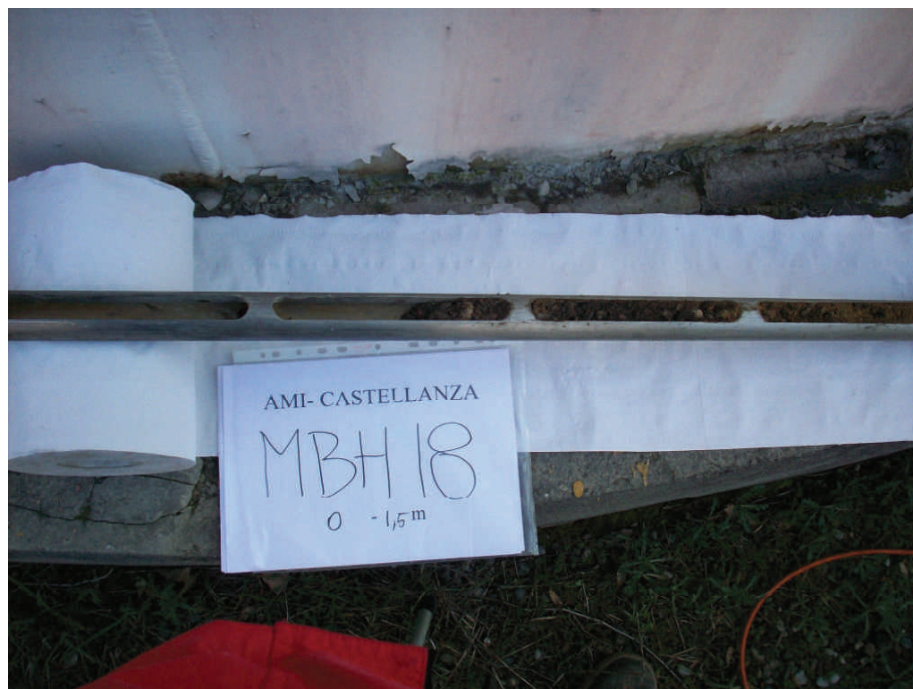
Figura .33 Microsondaggio MBH18 da 0 a 1,5 m da p.c.
