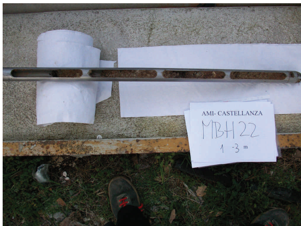
Figura .42 Microsondaggio MBH22 da 1 a 3 m da p.c.
