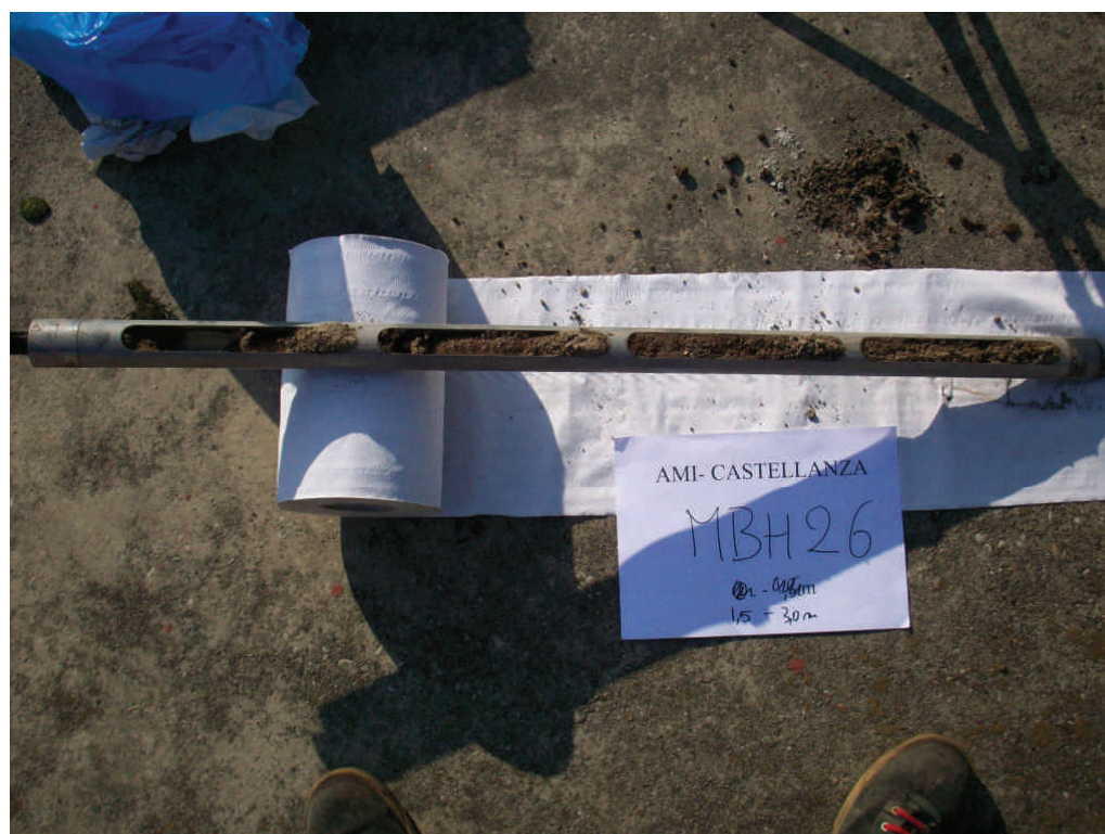
Figura .50 Microsondaggio MBH26 da 1,5 a 3 m da p.c.
