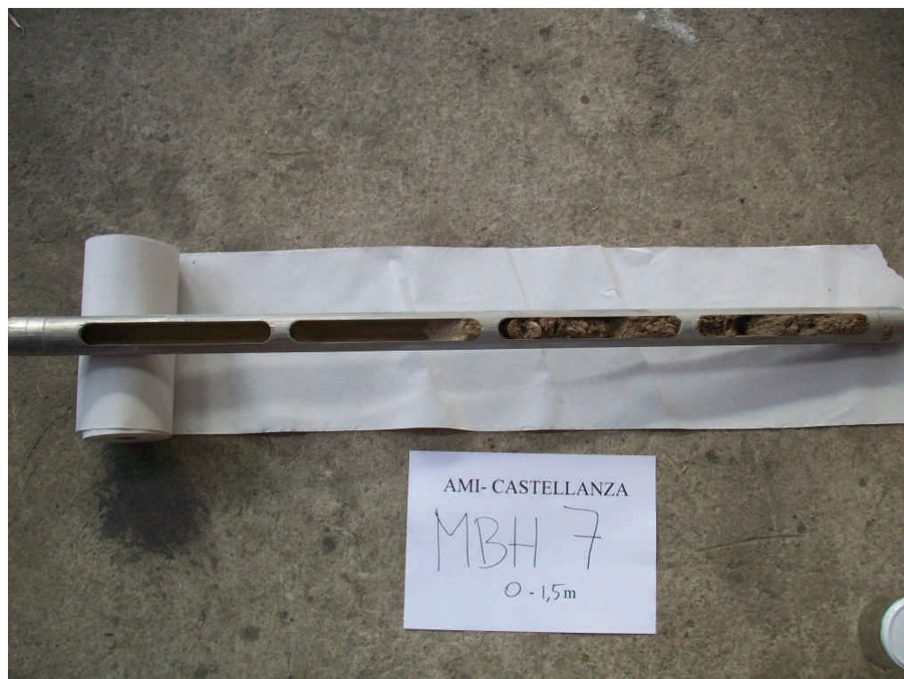
Figura.11 Microsondaggio MBH7 da 0 a 1,5 m da p.c.
