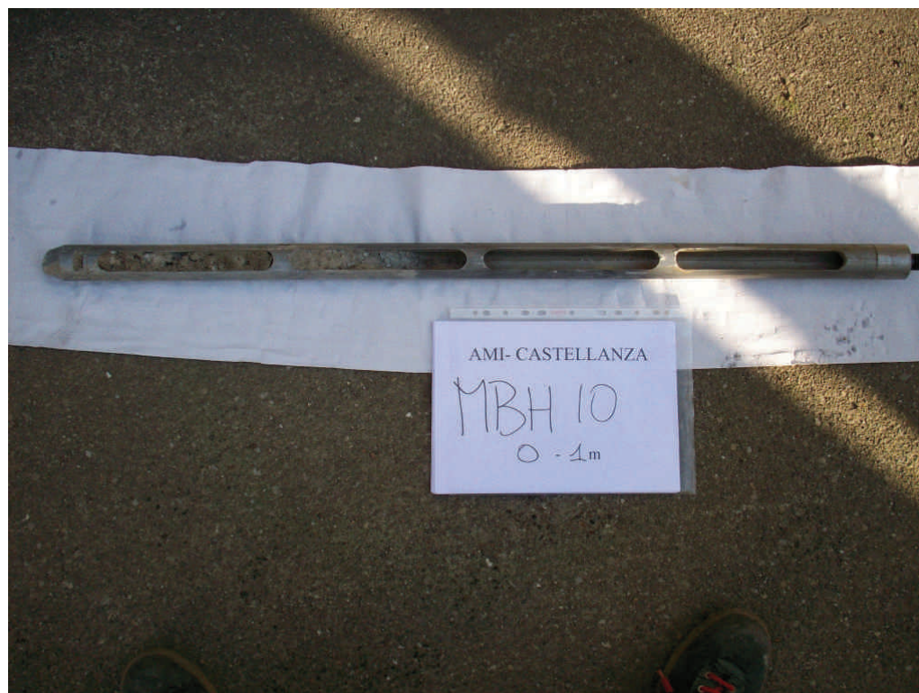
Figura.17 Microsondaggio MBH10 da 0 a 1 m da p.c.
