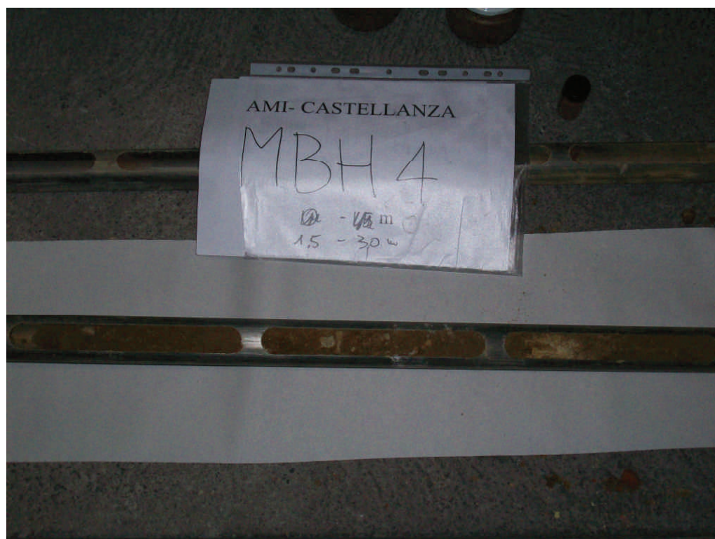
Figura .6 Microsondaggio MBH4 da 1,5 a 3 m da p.c.
