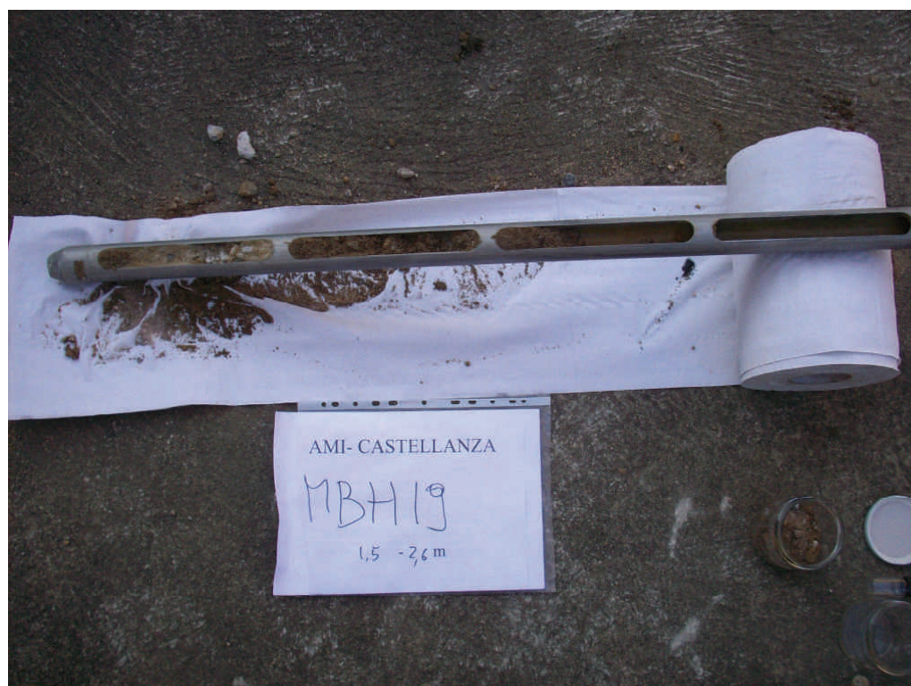
Figura .36 Microsondaggio MBH19 da 1,5 a 2,6 m da p.c.
