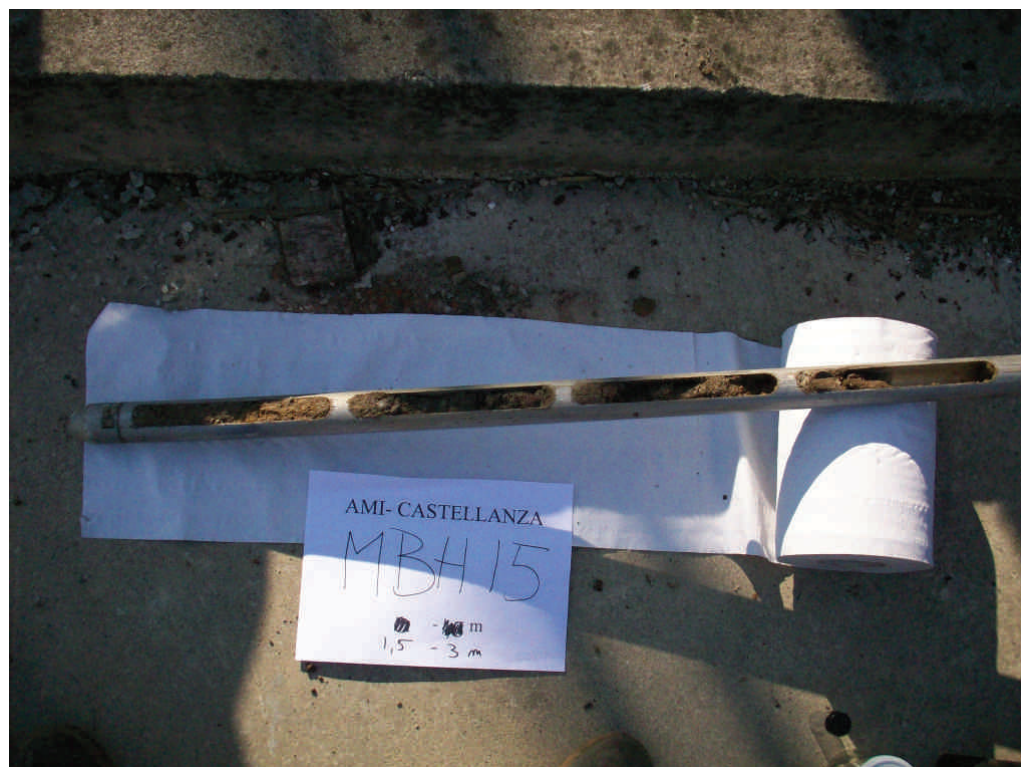
Figura .28 Microsondaggio MBH15 da 1,5 a 3 m da p.c.
