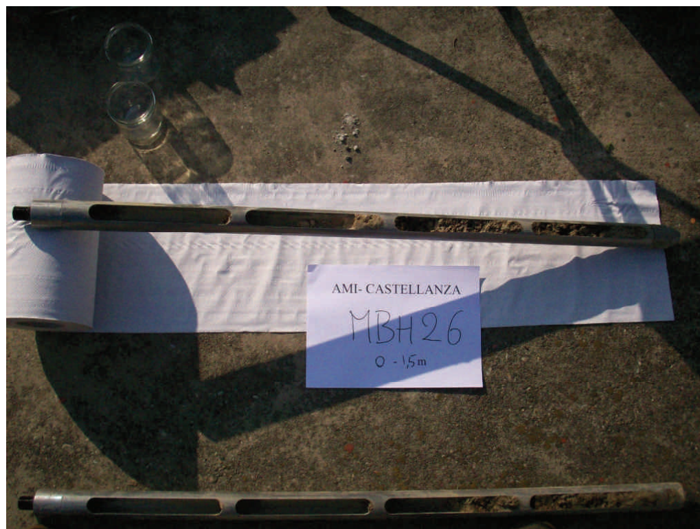
Figura .49 Microsondaggio MBH26 da 0 a 1,5 m da p.c.
