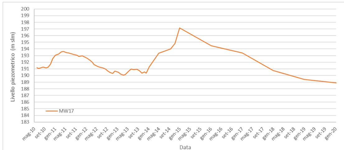
**Figura 2.4:** Zona C - Livelli piezometrici (m s.l.m.) presso il piezometro MW17
