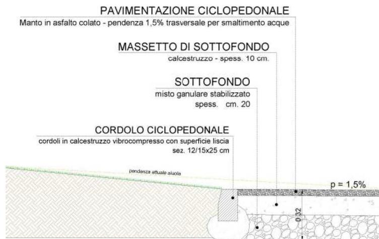
3. La pavimentazione del marciapiede è costituita da un pacchetto di spessore complessivo pari a 32 cm composto dai seguenti strati:
