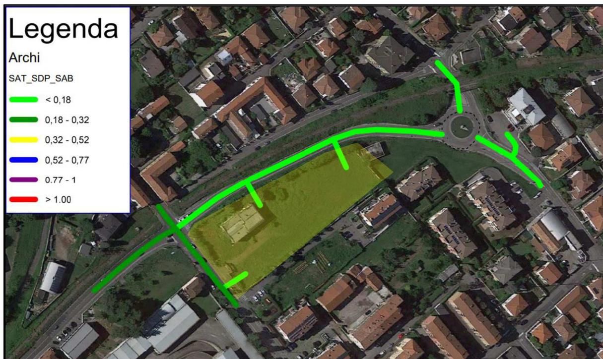
Figura 26 - Scenario SDP della sera del sabato. Flussogramma flusso/capacità della rete dell'area di studio
