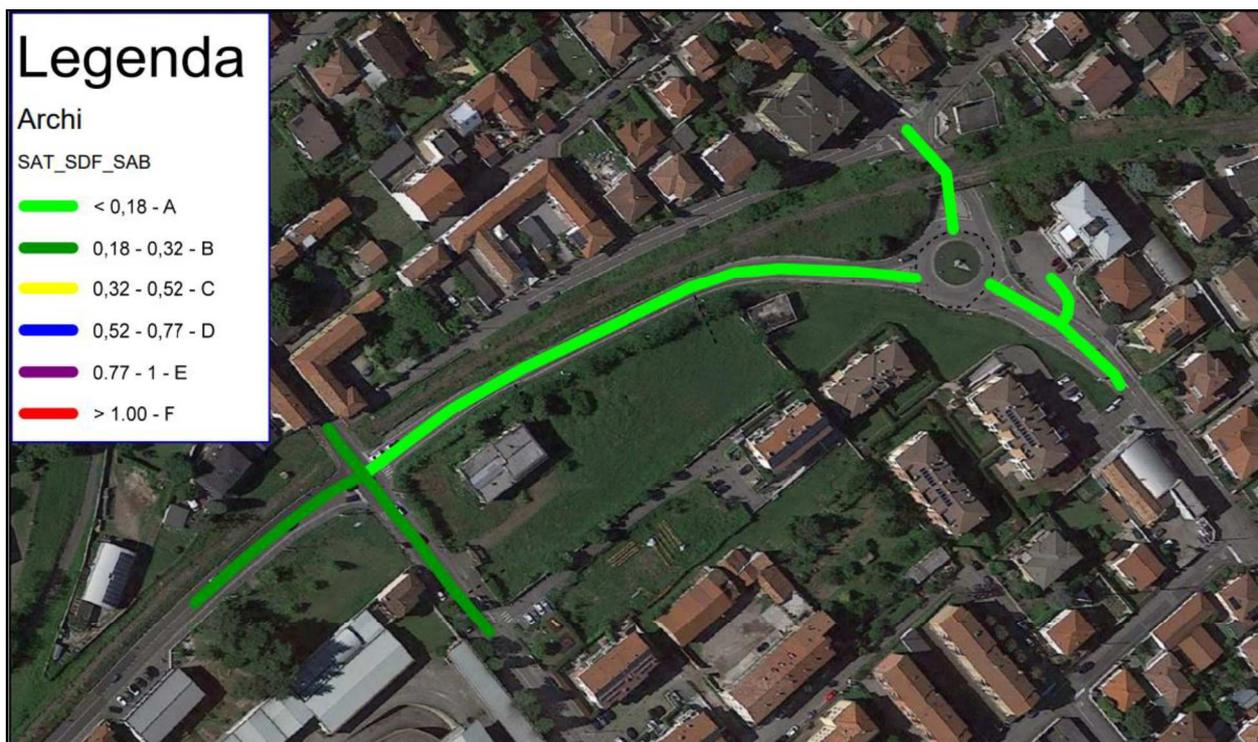
Figura 17 - Scenario SDF del sabato sera. Flussogramma flusso/capacità della rete dell'area di studio
