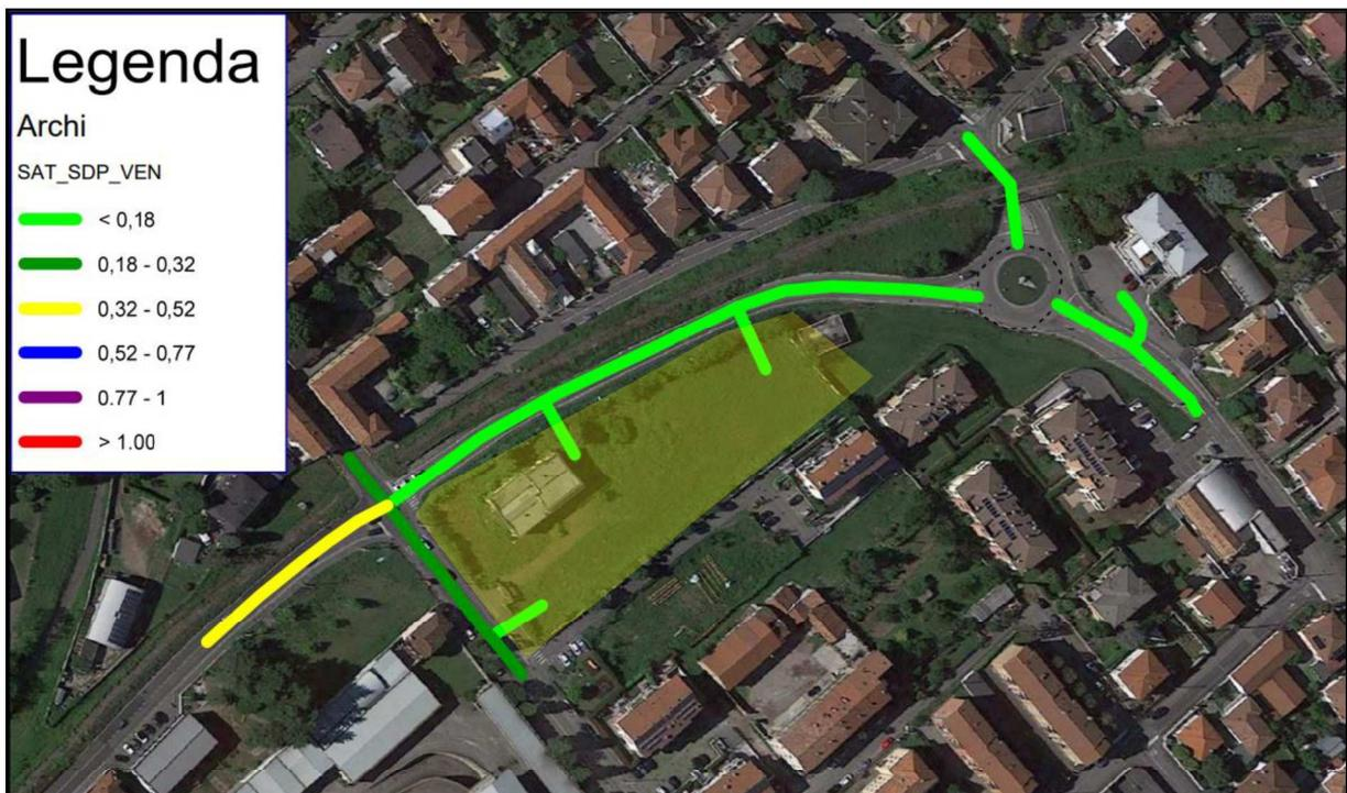
Figura 25 - Scenario SDP della sera del venerdì. Flussogramma flusso/capacità della rete dell’area di studio
