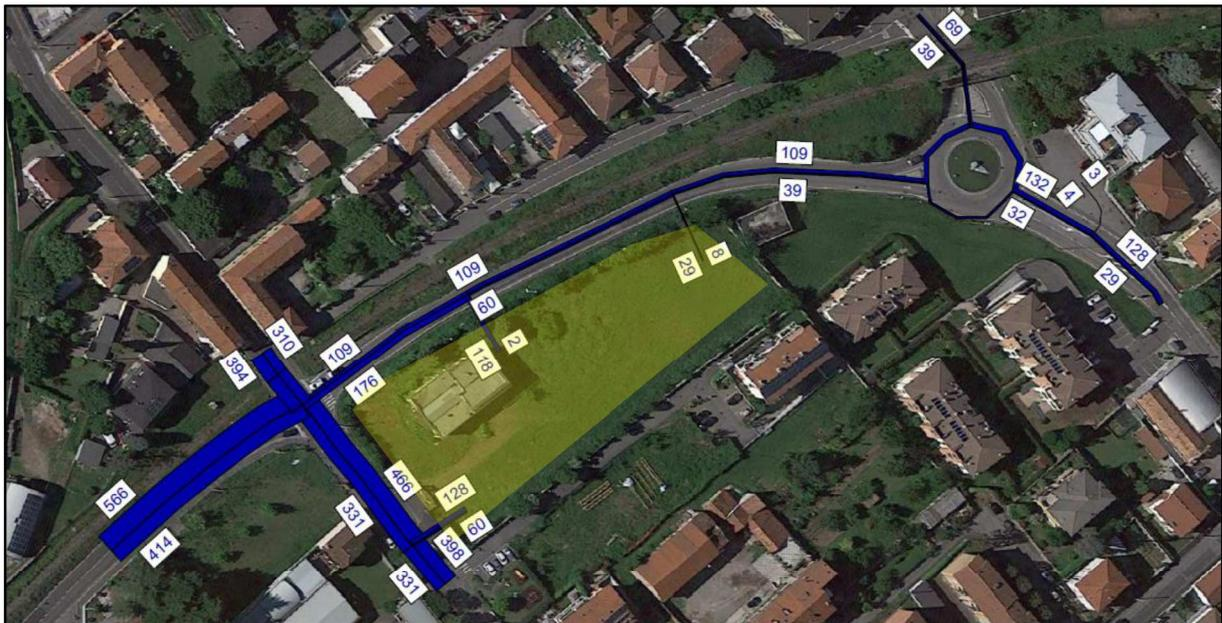
Figura 22 – SDP: flussogramma Odp serale del sabato [veicoli equivalenti]
