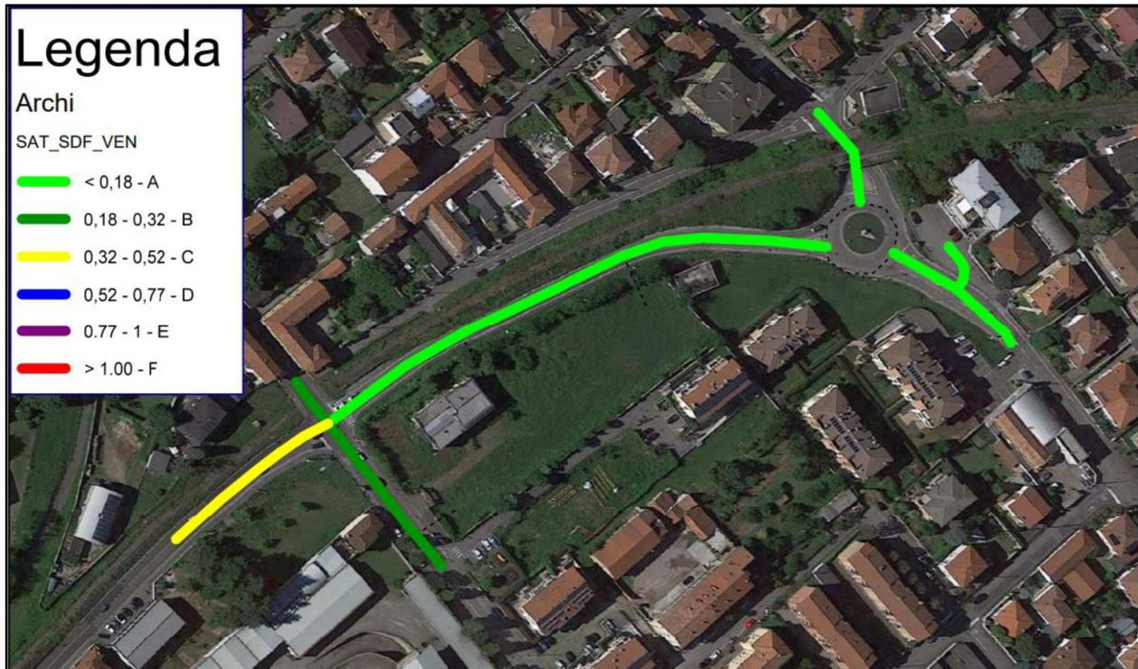
Figura 16 - Scenario SDF del venerdì sera. Flussogramma flusso/capacità della rete dell'area di studio
