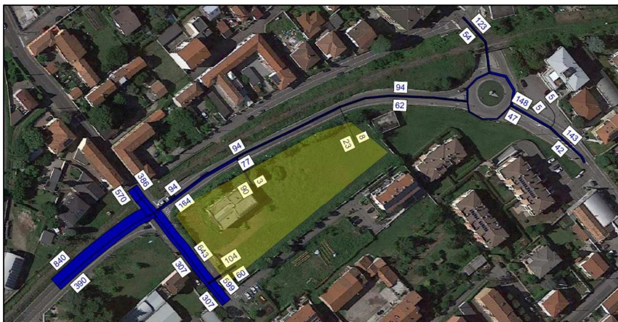
Figura 21 – SDP: flussogramma Odp serale del venerdì [veicoli equivalenti]
