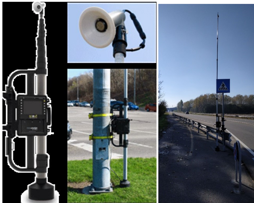
Figura 30 – Strumentazione video con palo telescopico
