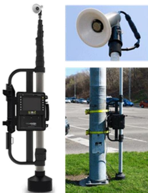
**Figura 20 – Strumentazione video con palo telescopico**
