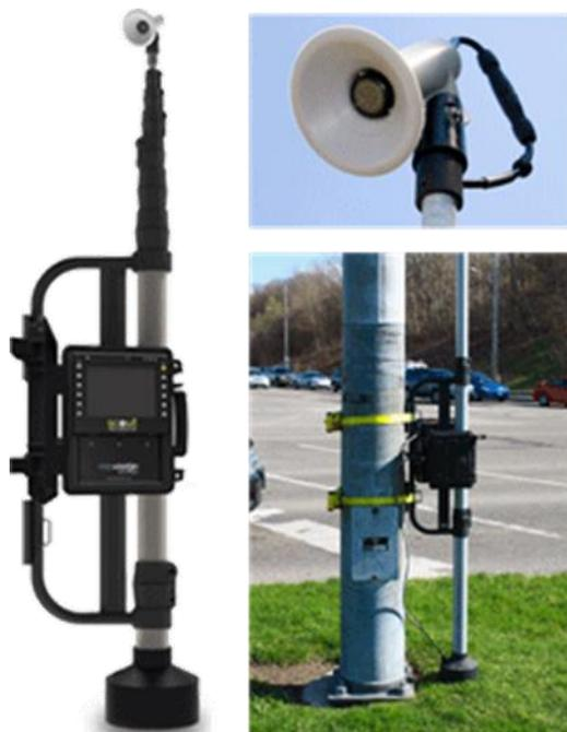
**Figura 22 – Strumentazione video con palo telescopico**
