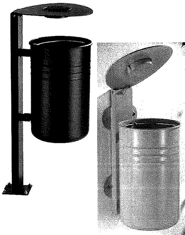
Contenitore a forma cilindrica con nervature, ottenuto dalla calandratura a freddo di lamiera prezinata spessore 10/10 , chiuso tramite elettrosaldatura.
