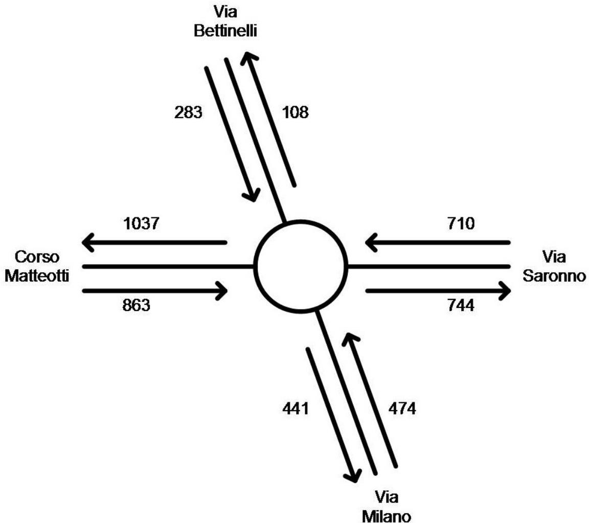
La rotatoria in esame ha un diametro  $D$  del cerchio inscritto pari a 38 m e due corsie di percorrenza dell'anello. L'inserimento nell'area di progetto sarà caratterizzato dalla seguente geometria:
