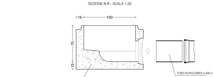
FABBRICAZIONE COMPLETAMENTE MONOLITICA IN UN UNICO GETTO, ANCHE LE BANCHINE ED IL CANALE DI SCOPPIO IN CLS SEC. C40/50 PER ACQUE BIANCHE O CLS SEC. A.R. C40/75 PER ACQUE NERE
