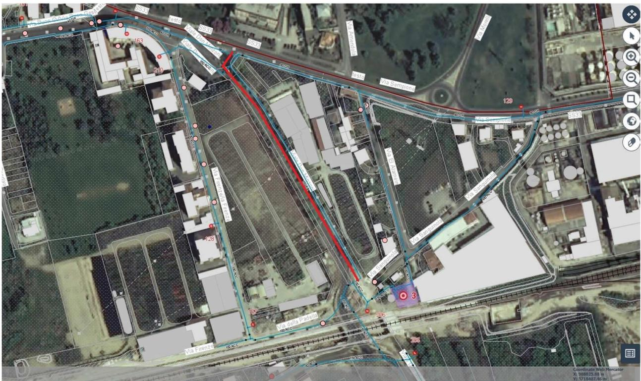
Figura 8 - Tracciato tubazione in sostituzione rete fibrocemento DN150 (in rosso)
